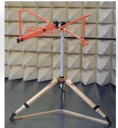
CBL 6143 horizontal onto BTP 6020A
