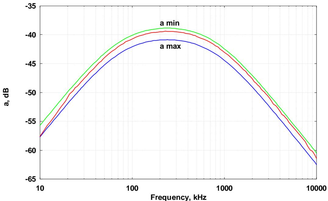
**Abb. 1 Transmission der Schutzschaltung**
