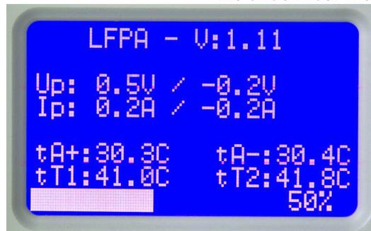
Angezeigt werden die aktuellen Spitzenwerte (Peak), getrennt nach der positiven und negativen Halbwelle.
