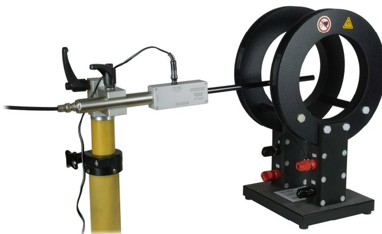
Abb. 6: Messaufbau Hall-Sensor in Helmholtz Spule
