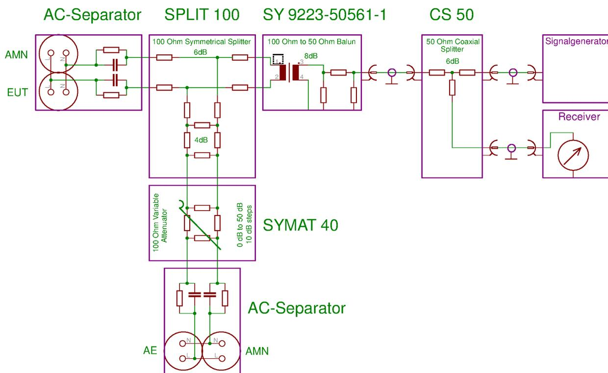
Abb. 1: Messaufbau nach EN-50561-1, Bild 4
