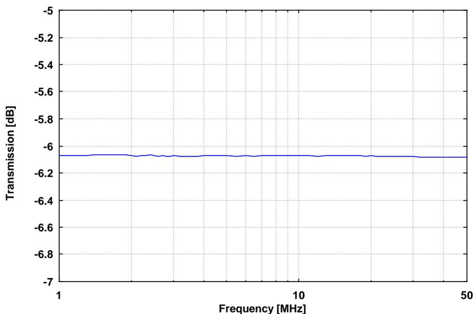
Bild 1: Typischer Übertragungsverlauf zwischen Port 1 und 2, Port 3 mit 100  $\Omega$  abgeschlossen
