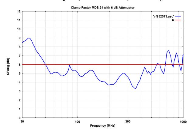
Mantelstromdämpfung (Entkopplung) im 50  $\Omega$ -System nach CISPR 16-1-3 Decoupling Factor measured in the 50  $\Omega$ -system acc. CISPR 16-1-3
